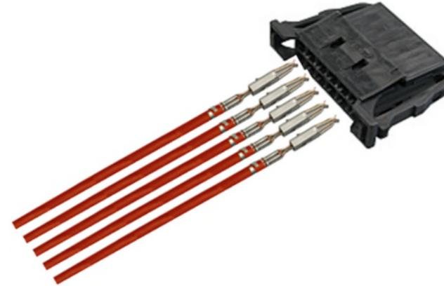
Beim Stiftgehäuse haben Sie zumeist eine innenliegende Sekundärverriegelung die Sie einfach mit einem passenden Schraubendreher "rein- bzw. randrücken" lässt, Sie hören auch hier ein leichtes "**Klick**", achten Sie aber darauf das die Kontakte beim Schließen der Sekundärverriegelung nicht verbogen werden. Oder aber wie im untenstehenden Beispiel ein Verriegelungsdeckel der mittels Filmscharnier einfach zugedrückt wird. Achten Sie darauf das beiden Seiten eingerastet sind.
